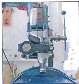
Bei der Fixierung eines Topfes kann zusätzlich eine Schablone zum Einsatz kommen.
