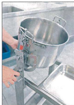
Der Topf kann fixiert werden und ist schwenkbar.
